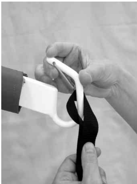
1. À deux mains pour sortir la sangle d'un crochet avec mousqueton : une main ouvre le mousqueton, l'autre fait sortir la sangle.
